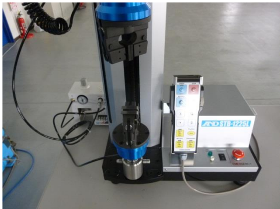
材料試験機(受入検査)
